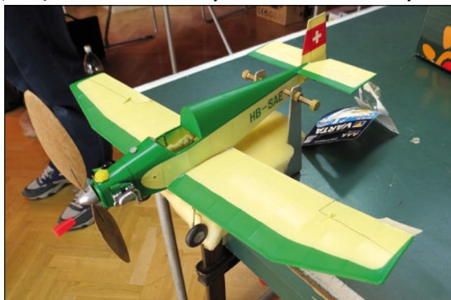
Zbrusu nový oříšek Tomáše Kocura Jodel D.9 v natáčecím stojanu. Oříšky je třeba před každým létáním nově seřizovat. Svoji roli hraje teplota a vlhkost v hale
