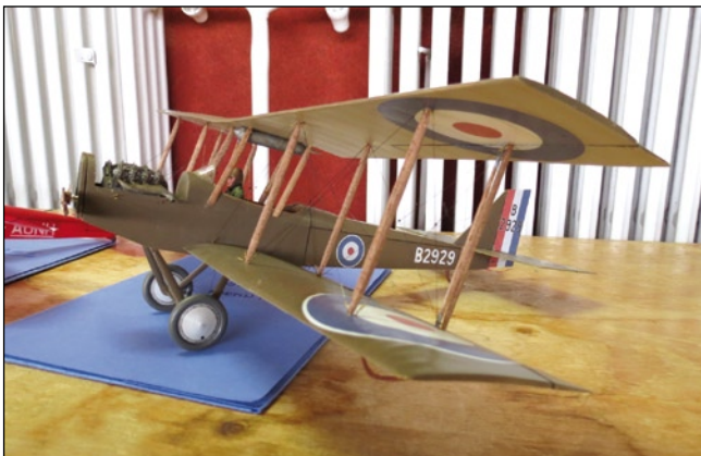
RC minimaketa DH-6 Martina Huka. Model je v měřítku 1:20, poháněn G-15W, napájení 1s LiPol 180 mAh, letová hmotnost 61 g. Řízeny jsou křídélka, VOP, SOP a otáčky motoru. Křídélka jsou řízena torzními uhlíkovými tyčkami o průměru 1,3 mm na spodním křídle a vzájemně propojena s křídélky na horním křídle. Model měl letošní RC premiéru, v minulosti létal jako volný model kategorie F4E
