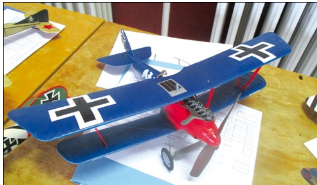
Vítězný Pfalz D.III Antonína Alferyho na gumu (F4D). Ve vzduchu působí, jako by pro něj nebylo nic přirozenějšího, než let. Model má polystyrénový trup a konstrukční plochy. Vyrábí se jako stavebnice short kit spolu s dalšími modely z WWI
