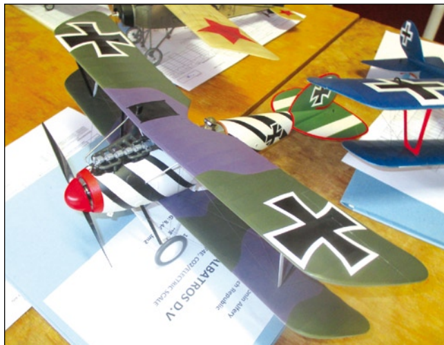
Albatros D.V Antonína Aferyho kategorie F4E v měřítku 1:20 je poháněn střídavým motorem, napájen 1s LiPol a řízen časovačem. Vyniká stabilním letem. V minulosti model létal jako dvacetinka poháněná gumou
